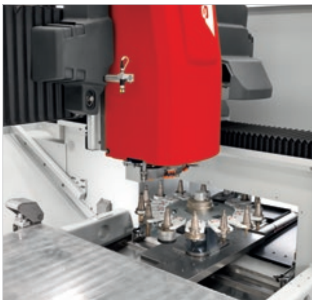
Depósito de ferramentas rotativo onde é possível carregar as ferramentas com total segurança enquanto a máquina trabalha.
