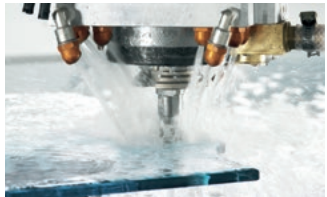
Perfuração pela parte de cima.
