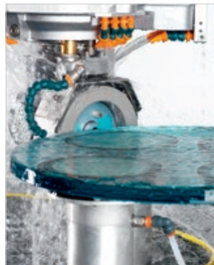
Desbaste com rebolo copo com agregado.
